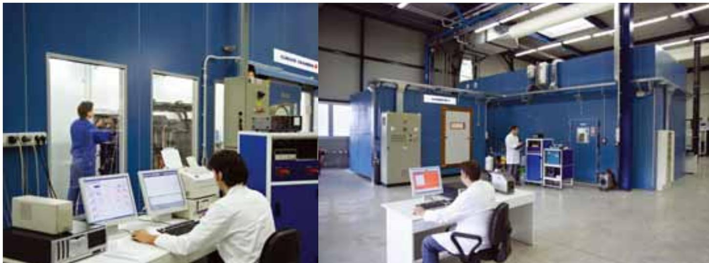
Rhoss R&D Lab è dotato delle apparecchiature necessarie alla valutazione delle prestazioni energetiche, aerauliche, termiche, elettriche, elettroniche e acustiche di tutti i refrigeratori fino a 1.500 kW.
